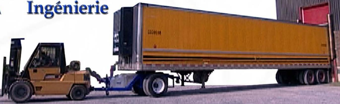
Le *COS180* de Cosinus est un outil de remorquage permettant de déplacer des remorques chargées à l'aide d'un chariot élévateur.
