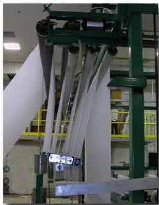
▶ Systeme de controle automatique de la tension du produit dans l'accumulateur.
